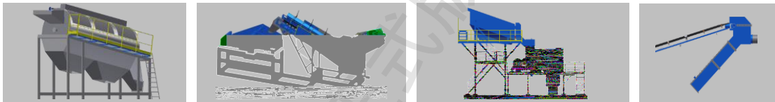
大块轻物质筛分模块：滚筒筛系列 水洗脱水模块：带式浮选机+脱水筛 风选模块：振动筛+风选机 成品风选模块：悬挂式风选机+皮带
